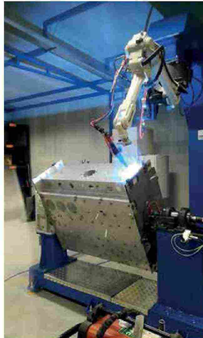
Un'applicazione di saldatura realizzata da Roboteco
