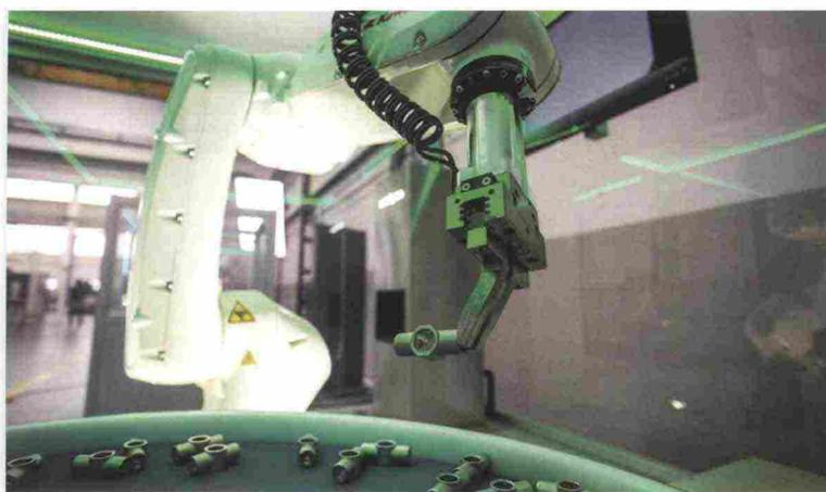
**Un'applicazione di bin-picking, prelievo di oggetti disposti alla rinfusa in un contenitore, per mezzo di uno speciale sistema di presa.**
