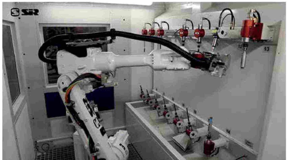
Un esempio di applicazione di un robot in un processo di finitura
