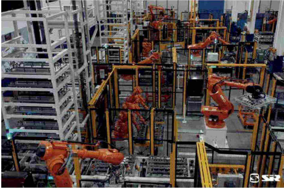
Un'applicazione robotizzata di assemblaggio anime in una fonderia realizzata da SIR
