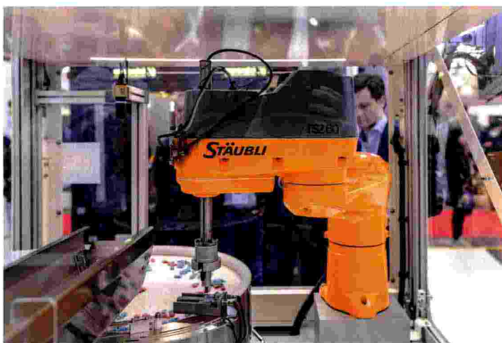
Un robot SCARA del produttore svizzero Stäubli in un'applicazione in integrazione al sistema Flexibowl di ARS, che consente la selezione e il prelevamento di pezzi.
