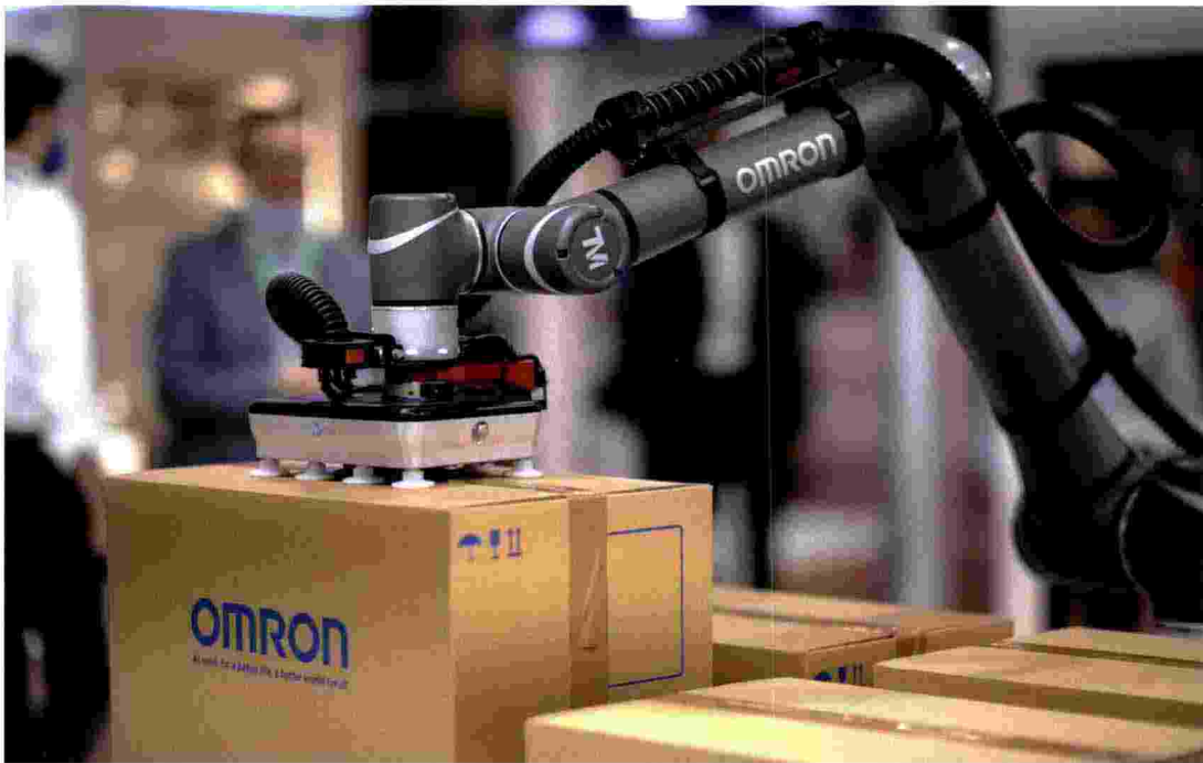
I robot collaborativi sono sempre più usati anche in logistica. Qui un'applicazione per la palletizzazione sviluppata da Omron.
