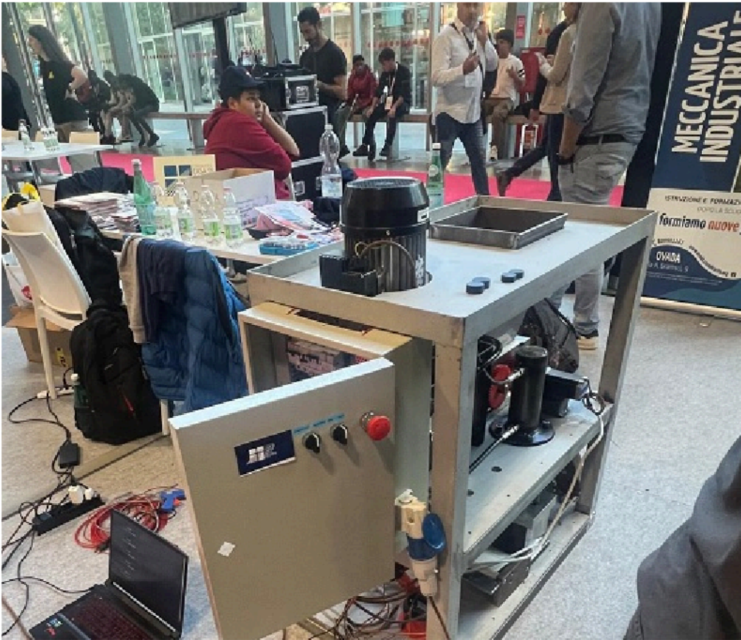
Il progetto GrindWoodPro de I Fabbri della Fondazione Casa di Carità Arti e Mestieri di Ovada (AL), secondo classificato a ROBOTGAMES 2024: un macchinario per automatizzare la triturazione di materiale legnoso di piccole dimensioni, interamente progettato e realizzato dagli studenti.
